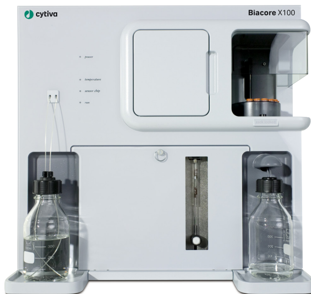
图 1. Biacore™ X100 是一款快速、可靠地检测分子相互作用的分析系统
